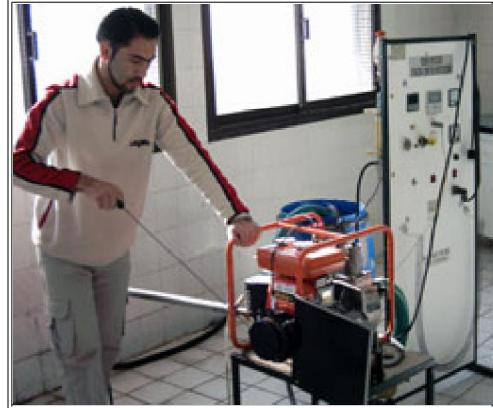
سوخت مصرفی را درون باک ( شماره ۷ ) تعبیه شده بریزید، شیر زیر باک باز کرده تا سوخت وارد استوانه مدرج ( شماره ۸ ) شود و به مقدار مشخصی برسد. حال موتور را روشن کرده به این ترتیب که دسته گاز را در حالت مینیمم قرار داده و استارت ( شماره ۱۲ ) را در حالت میانی قرار دهید. زمان را برای به دست آوردن دبی آب از کرونومتر بخوانید. دماهای ورودی و خروجی اگزو و همینطور دماهای آب ورودی و خروجی در مجاورت اگزو را یادداشت کنید. مقدار جریان و ولتاژ را نیز از روی پانل اندازه گیری بخوانید.
