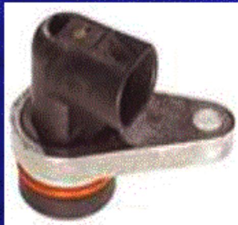
■ به کمک این سنسور، ECU علاوه بر اطلاع یافتن از رسیدن پیستونها به **TDC** (نقطه مرگ بالا)، از **سیکل کاری موتور (زمان تراکم، تخلیه و...)** نیز مطلع می شود و در نتیجه به راحتی می تواند در زمان مناسب برای هر سیلندر بطور مجزا سوخت مورد نیاز را در زمان تراکم و قبل از **TDC** از انژکتورها بیاشد (یک بار در هر سیکل کاری موتور برای هر سیلندر). بر این اساس از **میزان مصرف سوخت و آلاینده ها** کاسته می شود.
